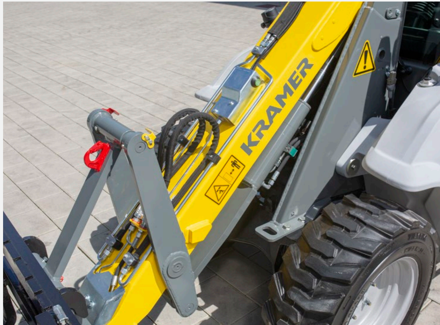
Robuste Ladeanlage mit Z-Kinematik, visueller Positionsanzeige und optionalem Lasthaken.
